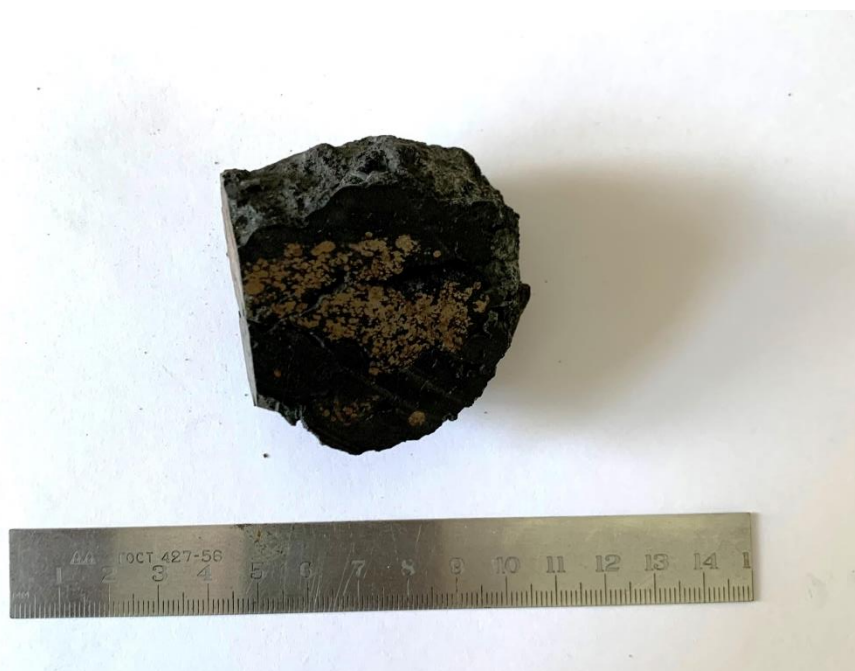
Рис. 2. Срез образца электросталеплавильного шлака Fig. 2. Section of a sample of electric steelmaking slag
