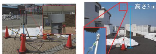
(a) トレーサーガス排出口 (b) トレーサーガス捕集
