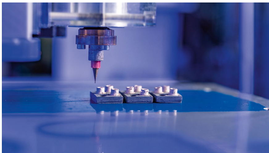
An der TU Chemnitz werden beim 3D-Druck von Gehäusen für leistungselektronische Bauelemente keramische und metallische Pasten genutzt, um die Bauteilgeometrie zu erzeugen. (© Jacob Müller)
