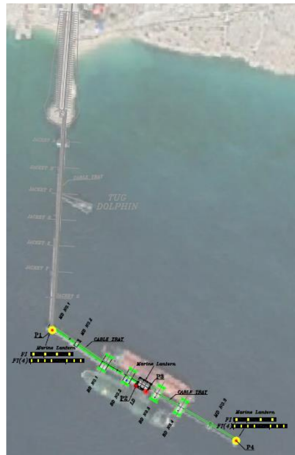
شکل ۱۴- جانمایی چراغ‌های دریایی اسکله نفتی لاوان
