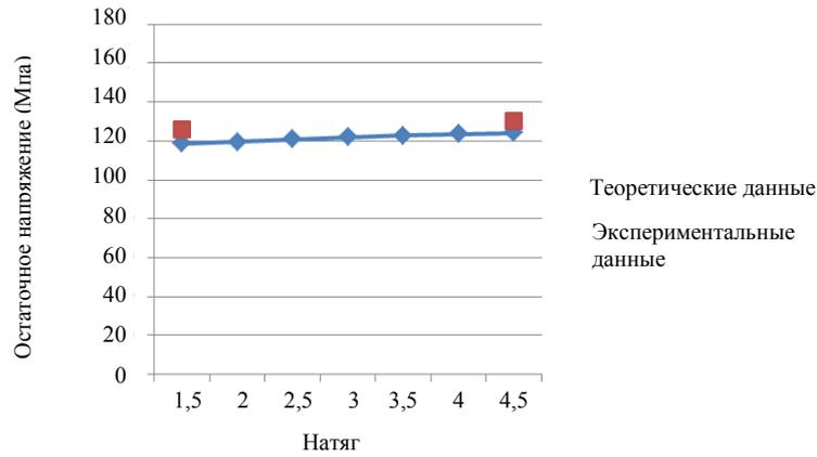
Рис. 3. Зависимость остаточных напряжений от натяга при обработке.
