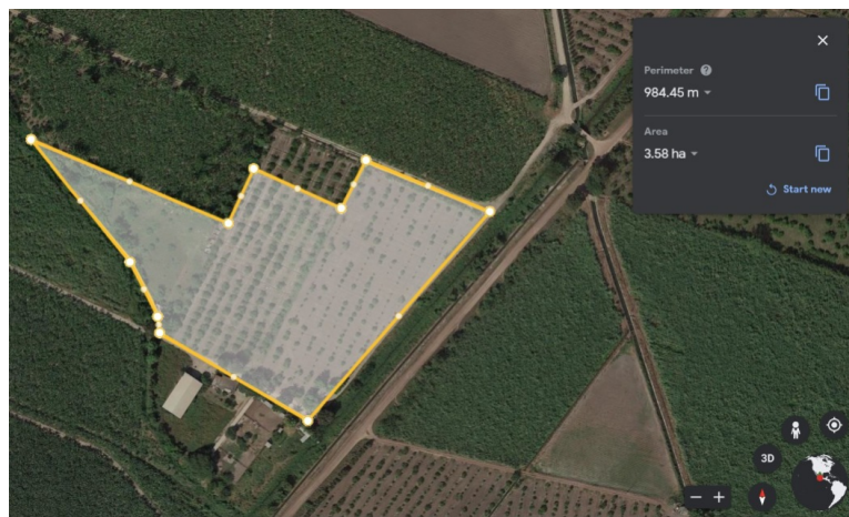
Fig. 2. Lanzamiento de los puntos GPS para la poligonal del terreno a analizar.
