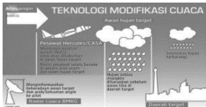
Gambar 2. Proses hujan buatan dengan wahana udara
