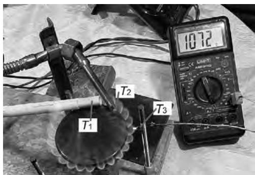
Рис. 2. Ілюстрація вимірювання температури полум'я трьома типами термоперетворювачів Fig. 2. An illustration of the measurement of flame temperature by three types of thermocouples
