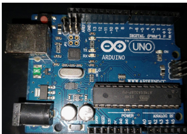
Figura 4. Placa Arduino Uno com microcontrolador ATMEGA 328.
