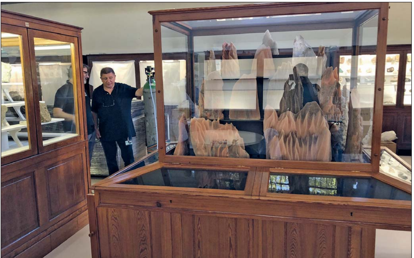
Fig. 15. Aspecte final de la vitrina expositiva a la que se li està injectant argó (bombona de color verd a la part esquerra) per millorar les condicions interiors d'humitat relativa. © M. Campeny – MCNB. Fig. 15. Injecting argon -green-colored cylinder on the left side- into the finished showcase in order to improve internal relative humidity.
