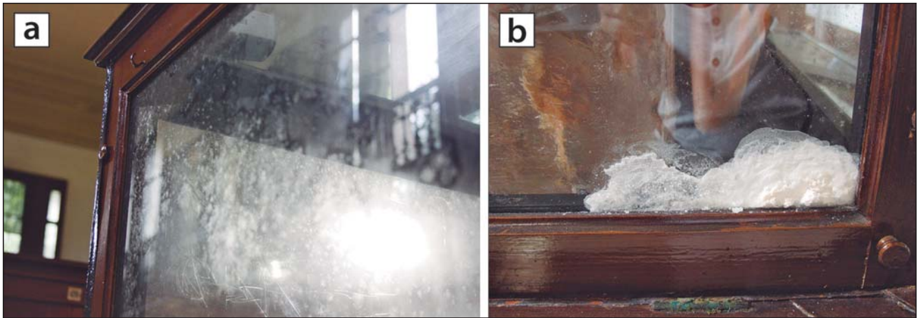
Fig. 7. a: cristal·litzacions concèntriques de sal desenvolupada sobre l'interior dels vidres de la vitrina; b: detall d'agregats de sal cristal·litzant a la superfície exterior de la vitrina. © M. Pérez – MCNB. Fig. 7. a: concentric salt crystals emerged on the inner surface of the showcase glass; b: detail of salt aggregates crystallizing on the outside surface of the showcase glass.
