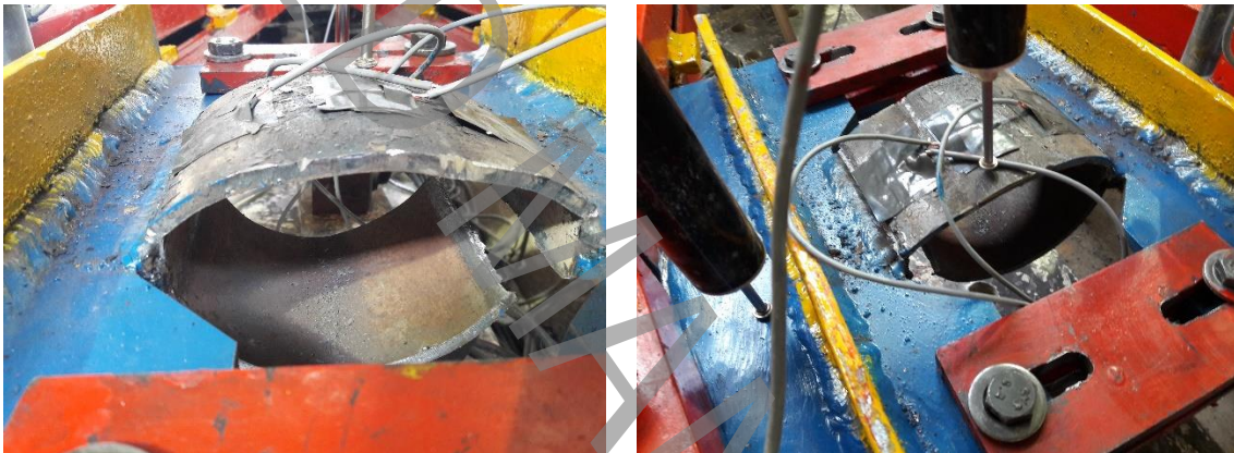
شکل ۱۲: خرابی در حلقه
