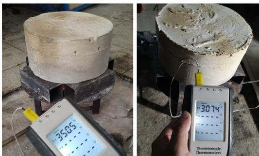
Gambar 3. Proses pre-heating pada cetakan
