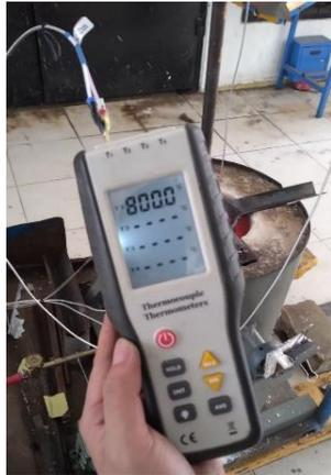
Gambar 2. Proses peleburan dan pengukuran temperatur logam cair
