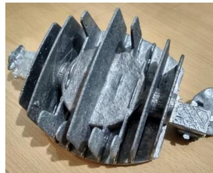
Gambar 11. Pre-heat 3500C kecepatan 30 rpm
