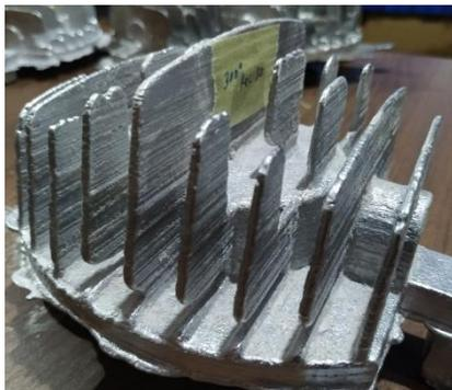
Gambar 8. Pre-heat 3000C kecepatan 30 rpm
