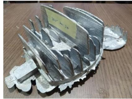
Gambar 10. Pre-heat 3500C kecepatan 20 rpm
